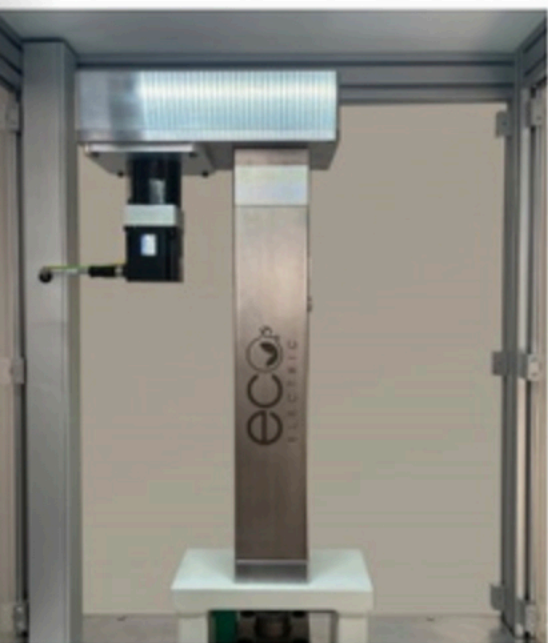
Gruppo Mondial ha fornito i cilindri EcoElectric di GTS per il banco di controllo qualità di valvole idrauliche ad alta pressione, sviluppato da Sia.
